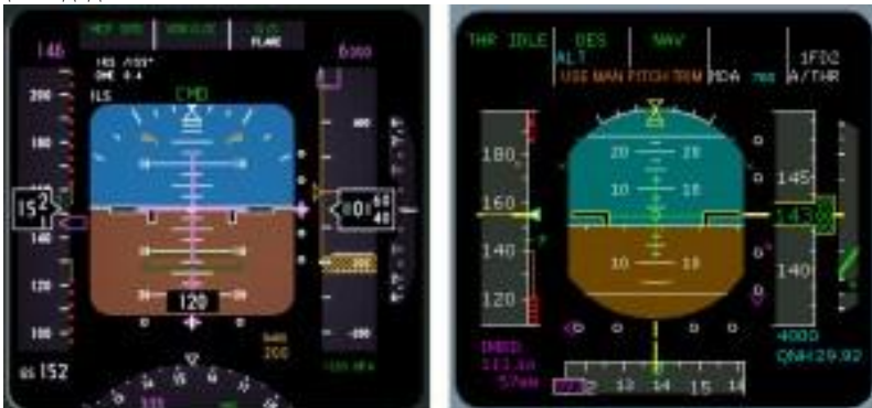
Фигура 5. Primary flight display на Боинг 737NG (ляво) и Еърбъс А320
