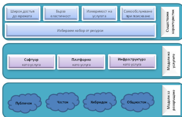
Фиг. 1. Обобщен модел на облачните изчисления.
