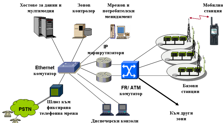
Фиг. 2. Архитектура на Автоматизирана мрежа за свързка с подвижни обекти на БА по стандарт TETRA.
