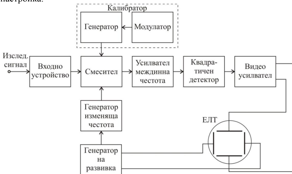
Фиг. 2. Схема на анализатор с автоматична пренастройка
