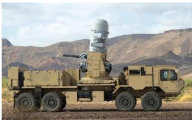
Артилерийска система за противодействие на артилерийски, минохвъргачни и реактивни боеприпаси Centurion Counter-Rocket, Artillery and Mortar systems (C-RAM)
