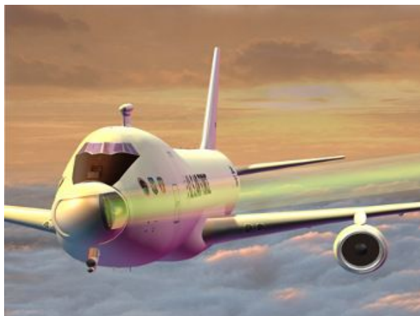
Самолет „Боинг 747 - 400F“ с монтирана лазерна система
