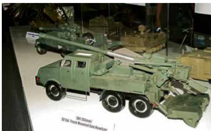
Китай разработва две различни самоходни колесни артилерийски системи - системата SH 1, снабдена със 155-mm оръдейно тяло с дължина 52 калибъра, и SH 2, снабдена със 122-mm оръдейно тяло
